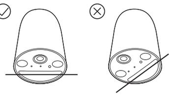
5. カメラの角度を水平から20°程度下に向けた角度で設置してください。
